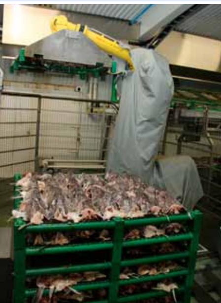
Radad í óða önn. Starfsfólkið radar á grindurnar en róbótinn staflar þeim í fulla hæð fyrir þurkklefana og léttir undir svo um munar.
